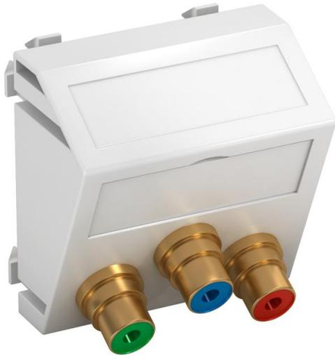
Support multimédia avec trois prises de raccordement Cinch pour Component Video, sortie de câbles oblique, avec champ d'inscription, trois raccordements Cinch (RCA) en version femelle-femelle, code couleur rouge/vert/bleu. Plaque-support avec fixation à encliqueter, adaptée au montage horizontal et vertical dans l'environnement du système.
