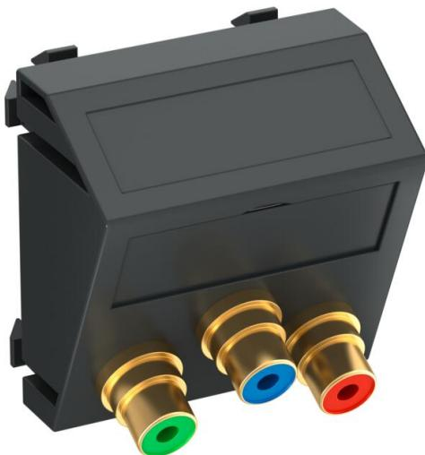
Support multimédia avec trois prises de raccordement Cinch pour Component Video, sortie de câbles oblique, avec champ d'inscription, trois prises Cinch (RCA) avec raccord soudé, code couleur rouge/vert/bleu. Plaque-support avec fixation à encliquer, adaptée au montage horizontal et vertical dans l'environnement du système.
