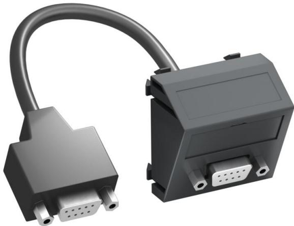
Support multimédia avec une prise de raccordement D-Sub9, sortie de câbles oblique, avec champ d'inscription, raccord D-Sub9 court (RS232) en version femelle-femelle. Plaque-support avec fixation à encliquer, adaptée au montage horizontal et vertical dans l'environnement du système.
