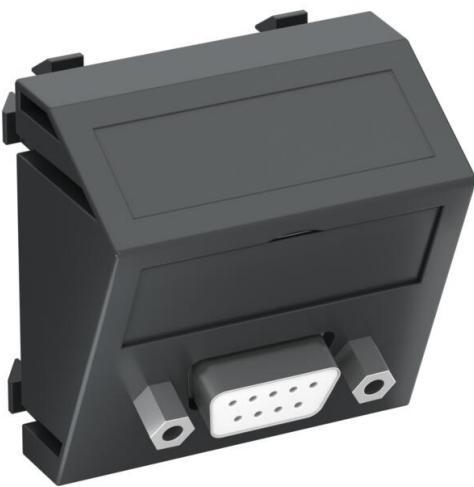
Support multimédia avec une prise de raccordement D-Sub9, sortie de câbles oblique, avec champ d'inscription, prise D-Sub9 (RS232) avec raccord à vis. Plaque-support avec fixation à encliquer, adaptée au montage horizontal et vertical dans l'environnement du système.
