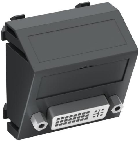
Support multimédia avec une prise de raccordement DVI-D, sortie de câbles oblique, avec champ d'inscription, prise femelle DVI-D avec raccord à vis. Plaque-support avec fixation à encliquer, adaptée au montage horizontal et vertical dans l'environnement du système.
