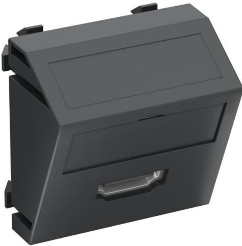
Support multimédia avec une prise de raccordement HDMI, sortie de câbles inclinée, avec porte-étiquette, prise HDMI avec raccord à vis. Plaque-support avec fixation à encliquer, adaptée au montage horizontal et vertical dans l'environnement du système.
