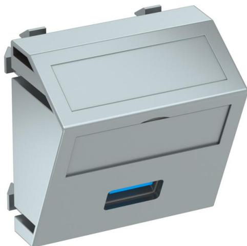
Support multimédia avec une prise de raccordement USB 3.0, sortie de câbles oblique, avec champ d'inscription, prise USB 3.0 type A avec raccord à vis. Plaque-support avec fixation à encliqueter, adaptée au montage horizontal et vertical dans l'environnement du système.
