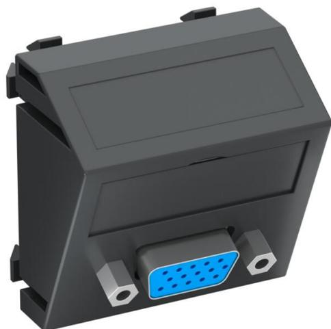
Support multimédia avec une prise de raccordement VGA, sortie de câbles oblique, avec champ d'inscription, prise VGA (HD15) avec raccord à vis. Plaque-support avec fixation à encliqueter, adaptée au montage horizontal et vertical dans l'environnement du système.
