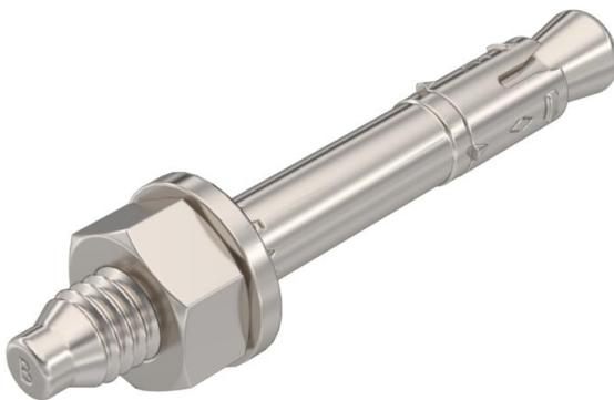
La cheville à collerette N est utilisable pour des fixations multiples de systèmes non porteurs à l'intérieur et à l'extérieur dans du béton fissuré et non fissuré, elle conjugue les avantages d'un boulon d'ancrage et d'une simplicité accrue de montage.
