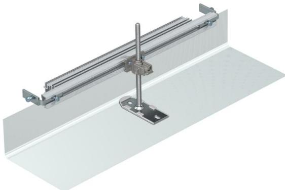
Fermeture de conduit prêt à monter, composé d'un tablier flexible avec profilés latéraux et profilés d'insertion de revêtement de sol. Des équerres de raccordement de conduit et une équerre de fixation réglable en hauteur font partie des fournitures.
