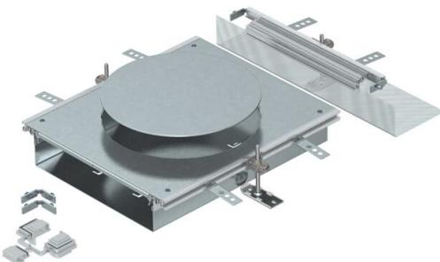
Unité d'extension de conduit prête à monter avec un couvercle de montage d'appareillage pour un boîtier de sol de taille nominale R9, composée d'un socle (plaqué de sol avec profilés latéraux et d'insertion de revêtement de sol), d'un couvercle avec ouverture de montage obturée et d'un embout. 3 équerres de fixation réglables en hauteur, 3 chevilles à expansion pour béton, 1 support de contact de couvercle et 1 kit pour angle de dérivation sont fournis à la livraison.
