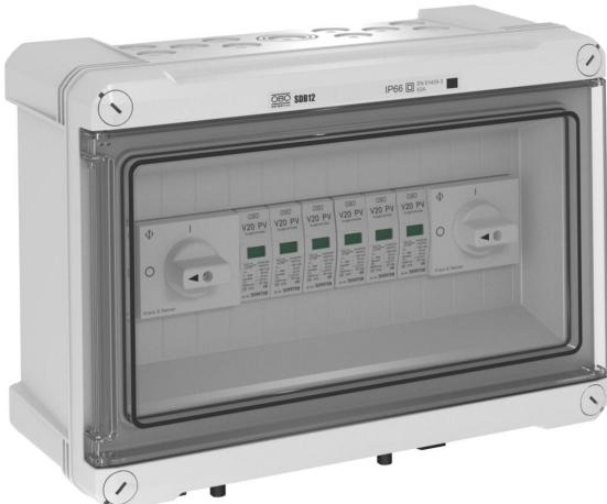
Solution système de type 2 avec connecteur mâle MC4 et disjoncteur pour onduleur photovoltaïque avec 2 tracker MPP, 1000 V CC
