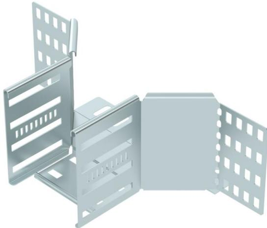
Dérivation à monter pour créer une dérivation horizontale ou une croix, pièce de forme pour chemins de câbles encliquetables et vissables d'une hauteur d'aile de 110 mm. Montage sans vis avec bornes doubles ou raccord vissé avec vis à tête bombée FRS et écrous à rondelle sertie M6. Utilisable en intérieur. Le matériel de fixation doit être commandé séparément.
