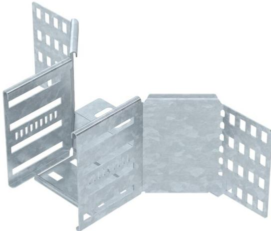
Dérivation à monter pour créer une dérivation horizontale ou une croix, pièce de forme pour chemins de câbles encliquetables et vissables d'une hauteur d'aile de 110 mm. Montage sans vis avec bornes doubles ou raccord vissé avec vis à tête bombée FRS et écrous à rondelle sertie M6. Utilisable en intérieur et en extérieur. Le matériel de fixation doit être commandé séparément.
