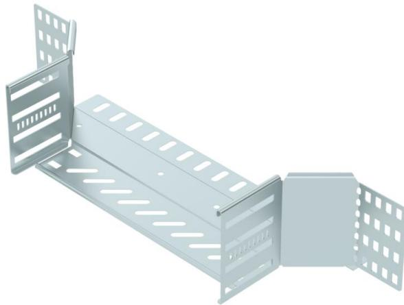
Dérivation à monter pour créer une dérivation horizontale ou une croix, pièce de forme pour chemins de câbles encliquetables et vissables d'une hauteur d'aile de 110 mm. Montage sans vis avec bornes doubles ou raccord vissé avec vis à tête bombée FRS et écrous à rondelle sertie M6. Utilisable en intérieur. Le matériel de fixation doit être commandé séparément.
