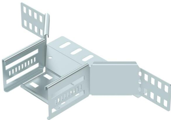
Dérivation à monter pour créer une dérivation horizontale ou une croix, pièce de forme pour chemins de câbles encliquetables et vissables d'une hauteur d'aile de 60 mm. Montage sans vis avec bornes doubles ou raccord vissé avec vis à tête bombée FRS et écrous à rondelle sertie M6. Utilisable en intérieur. Le matériel de fixation doit être commandé séparément.
