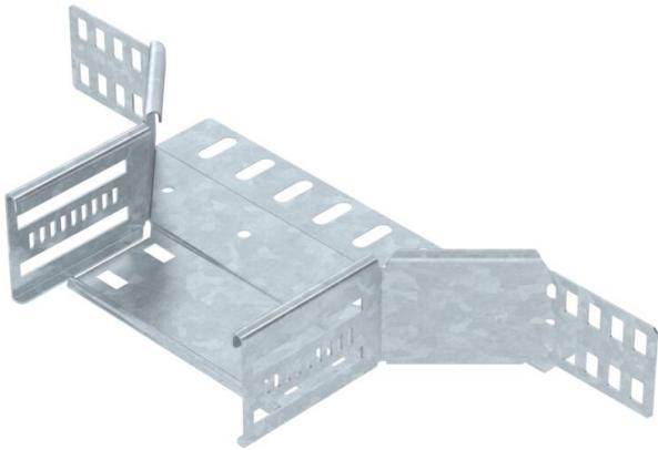
Dérivation à monter pour créer une dérivation horizontale ou une croix, pièce de forme pour chemins de câbles encliquetables et vissables d'une hauteur d'aile de 60 mm. Montage sans vis avec bornes doubles ou raccord vissé avec vis à tête bombée FRS et écrous à rondelle sertie M6. Utilisable en intérieur et en extérieur. Le matériel de fixation doit être commandé séparément.
