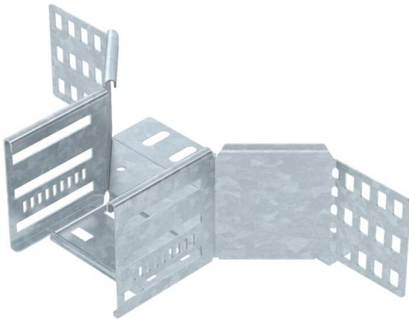
Dérivation à monter pour créer une dérivation horizontale ou une croix, pièce de forme pour chemins de câbles encliquetables et vissables d'une hauteur d'aile de 85 mm. Montage sans vis avec bornes doubles ou raccord vissé avec vis à tête bombée FRS et écrous à rondelle sertie M6. Utilisable en intérieur et en extérieur. Le matériel de fixation doit être commandé séparément.
