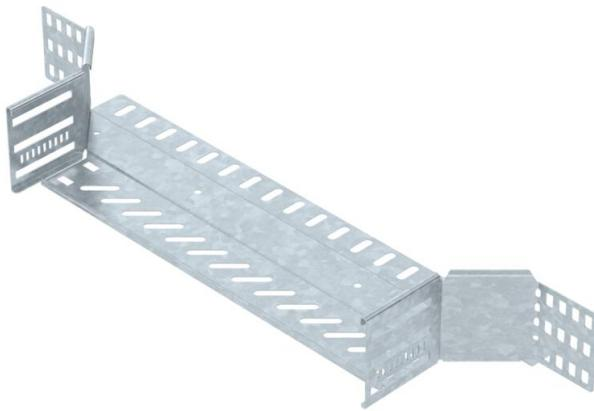
Dérivation à monter pour créer une dérivation horizontale ou une croix, pièce de forme pour chemins de câbles encliquetables et vissables d'une hauteur d'aile de 85 mm. Montage sans vis avec bornes doubles ou raccord vissé avec vis à tête bombée FRS et écrous à rondelle sertie M6. Utilisable en intérieur et en extérieur. Le matériel de fixation doit être commandé séparément.
