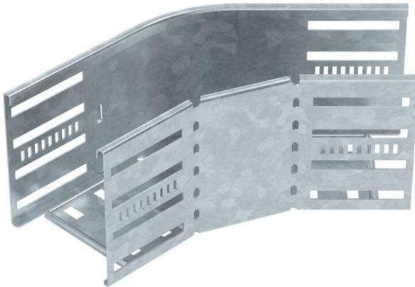
Coude à 45° pour créer une dérivation horizontale, pièce de forme pour chemins de câbles encliquetables et vissables d'une hauteur d'aile de 110 mm. Montage sans vis avec bornes doubles ou raccord vissé avec vis à tête bombée FRS et écrous à rondelle sertie M6. Utilisable en intérieur et en extérieur. Le matériel de fixation doit être commandé séparément.
