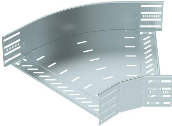
Coude à 45° pour créer une dérivation horizontale, pièce de forme pour chemins de câbles encliquetables et vissables d'une hauteur d'aile de 110 mm. Montage sans vis avec bornes doubles ou raccord vissé avec vis à tête bombée FRS et écrous à rondelle sertie M6. Utilisable en intérieur. Le matériel de fixation doit être commandé séparément.
