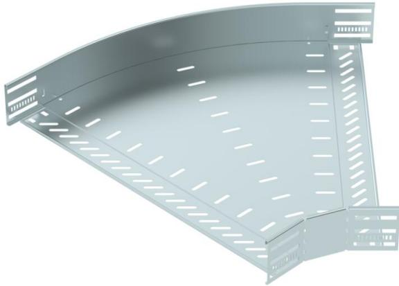
Coude à 45° pour créer une dérivation horizontale, pièce de forme pour chemins de câbles encliquetables et vissables d'une hauteur d'aile de 85 mm. Montage sans vis avec bornes doubles ou raccord vissé avec vis à tête bombée FRS et écrous à rondelle sertie M6. Utilisable en intérieur. Le matériel de fixation doit être commandé séparément.
