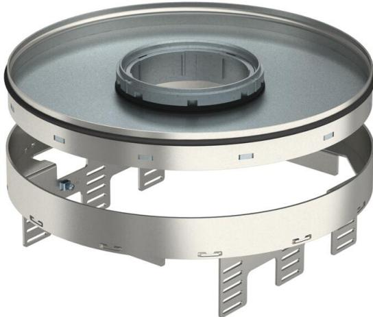
Cassette réglable en hauteur et découpée par rapport au plancher de taille nominale R9, pour tube, pour le montage d'appareillages dans des planchers nettoyés à sec ou à l'eau en intérieur, pour le montage dans des boîtes de tirage UZD350-3 en association avec un couvercle de montage DUG350-3R9 ou dans des boîtes de tirage UGD350-3R9. Le montage s'effectue à l'aide d'équerres de nivellement (à commander séparément) dans le profilé de cadre en aluminium des boîtes de tirage.
