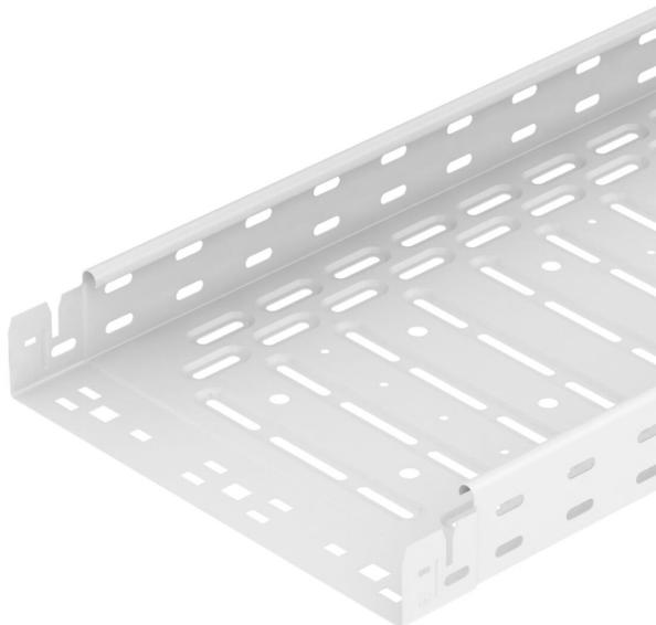
Chemin de câbles avec système de fixation rapide intégré Perforation latérale continue de 7 x 20 mm pour l'installation d'éléments de montage et de raccordement supplémentaires Avec perforation centrale de 11 mm au fond pour la suspension directe par tige filetée. Longueur utile 3 000 m.
