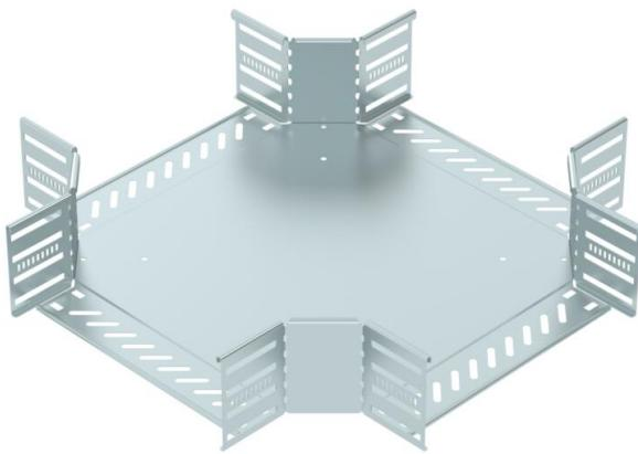
Croix pour créer une dérivation horizontale, pièce de forme pour chemins de câbles encliquetables et vissables d'une hauteur d'aile de 110 mm. Montage sans vis avec bornes doubles ou raccord vissé avec vis à tête bombée FRS écrous à rondelle sertie M6. Utilisable en intérieur. Le matériel de fixation doit être commandé séparément.
