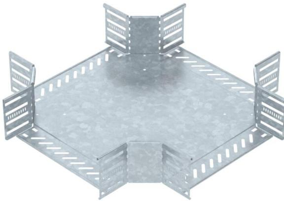
Croix pour créer une dérivation horizontale, pièce de forme pour chemins de câbles encliquetables et vissables d'une hauteur d'aile de 110 mm. Montage sans vis avec bornes doubles ou raccord vissé avec vis à tête bombée FRS écrous à rondelle sertie M6. Utilisable en intérieur et en extérieur. Le matériel de fixation doit être commandé séparément.
