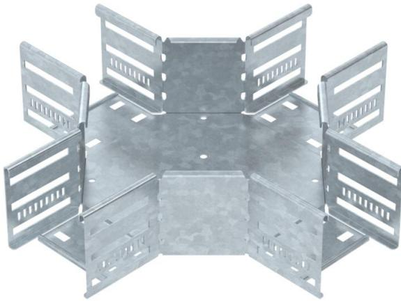
Croix pour créer une dérivation horizontale, pièce de forme pour chemins de câbles encliquetables et visssables d'une hauteur d'aile de 85 mm. Montage sans vis avec bornes doubles ou raccord vissé avec vis à tête bombée FRS et écrous à rondelle sertie M6. Utilisable en intérieur et en extérieur. Le matériel de fixation doit être commandé séparément.
