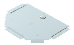
Couvercle pour pièce de forme pièce en T pour chemins de câbles encliquetables et vissables en intérieur, pour protéger le câble contre les dommages et la saleté. Fixation avec verrou tournant prémonté et fixation par appui sur le couvercle pour chemin de câbles. Convient à toutes les hauteurs d'ailes. Le couvercle peut être utilisé avec des pièces de forme de toutes hauteurs d'ailes
