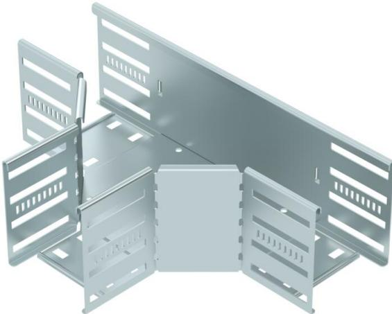
Pièce en T pour créer une dérivation horizontale, pièce de forme pour chemins de câbles encliquetables et vissables d'une hauteur d'aile de 110 mm. Montage sans vis avec bornes doubles ou raccord vissé avec vis à tête bombée FRS et écrous à rondelle sertie M6. Utilisable en intérieur. Le matériel de fixation doit être commandé séparément.
