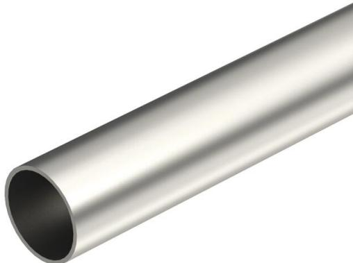
Tube d'installation électrique sans extrémités filetées selon la norme EN 61386-1, pour la protection mécanique de câbles et de conducteurs. Avec paroi intérieure sans ébarbure. Classe de protection anticorrosion 4 (élevée).
