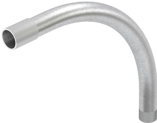
Coude à 90° pour les tubes électriques selon EN 61386-1, équipés d'extrémités filetées selon DIN 60423. Avec paroi intérieure sans ébarbure.
