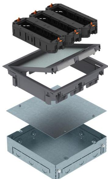
Boîte sous chape carrée avec boîtier de sol GES9 pour installation dans des chapes en intérieur. Avec ouvertures d'insertion défonçables pour tubes (M25), sur les quatre côtés.
