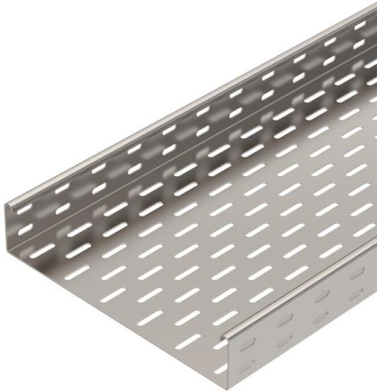
SKS 60 = Système de chemins de câbles lourd d'une hauteur latérale de 60 mm. Les raccords doivent être commandés séparément en quantité nécessaire. Atténuation magnétique du blindage sans couvercle 20 dB, avec couvercle 50 dB.
