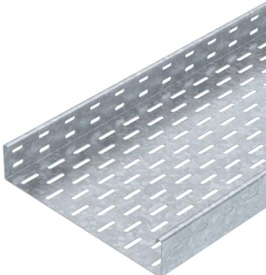
SKS 60 = Système de chemins de câbles lourd d'une hauteur latérale de 60 mm. Le chemin de câbles type SKS peut également être utilisé pour le maintien en fonction. Pour d'autres informations, se reporter aux systèmes de protection contre les incendies BSS ; Kit d'éclissage droit type RV 60 inclus dans la livraison. Atténuation magnétique du blindage sans couvercle 20 dB, avec couvercle 50 dB.
