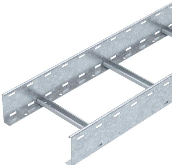
Échelle à câbles d'une hauteur d'aile de 110 mm avec échelons soudés à profilé C30 ouvert vers le haut. Longerons latéraux enroulés pour le renforcement et la protection des bords. La fixation sur console s'effectue avec des pièces de serrage de type LKS 40. La fente de l'échelon mesure 16,5 mm. La bride de fixation correspondante est de type 2056.
