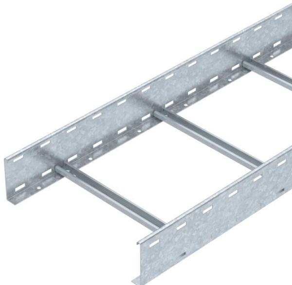
Échelle à câbles d'une hauteur d'aile de 110 mm avec échelons soudés à profilé C30 ouvert vers le haut. Longerons latéraux enroulés pour le renforcement et la protection des bords. La fixation sur console s'effectue avec des pièces de serrage de type LKS 40. La fente de l'échelon mesure 16,5 mm. La bride de fixation correspondante est de type 2056.
