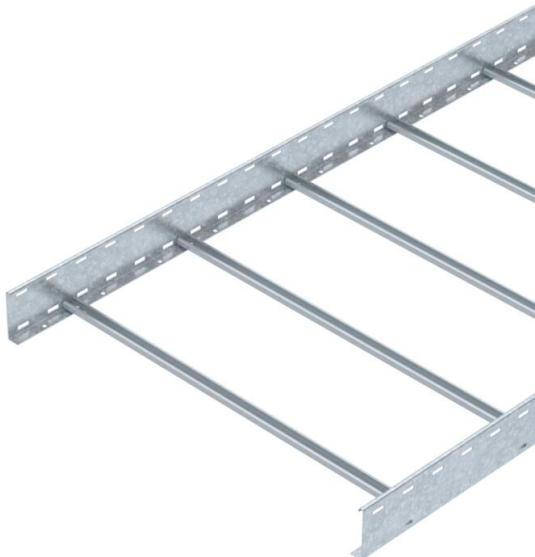
Échelle à câbles d'une hauteur d'aile de 110 mm avec échelons soudés à profilé C30 ouvert vers le haut. Longerons latéraux enroulés pour le renforcement et la protection des bords. La fixation sur console s'effectue avec des pièces de serrage de type LKS 40. La fente de l'échelon mesure 16,5 mm. La bride de fixation correspondante est de type 2056.
