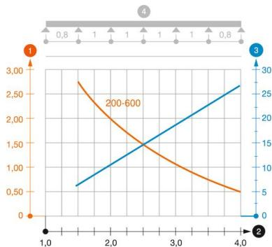
Diagramme de charge de l'échelle à câbles type SLG 45 NS
