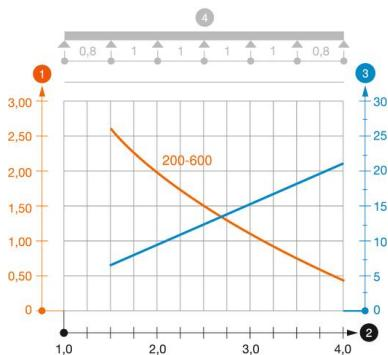
Diagramme de charge échelle à câbles type SLG 60 NS
