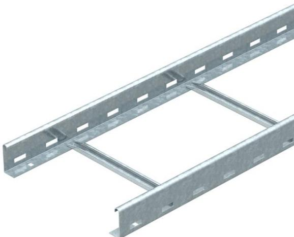
Échelle à câbles d'une hauteur latérale de 60 mm avec échelons rivetés (profilé en C) ouverts vers le haut. Longerons latéraux roulés pour le renforcement et la protection des bords. Longerons latéraux enroulés pour le renforcement et la protection des bords. La fixation sur console s'effectue avec des pièces de serrage de type LKS 40. La ouverture de l'échelon mesure 11 mm, la bride de fixation correspondante est de type 2056/ N.
