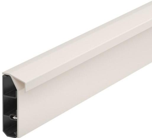
Goulotte sous plinthe SL-T pour la distribution encastrée des câbles à l'intérieur. La couleur de la partie inférieure peut avoir de nuances dû à la fabrication. Avec couvercle emboitable et partie inférieure perforée au fond pour un montage direct au mur. Effectuer des changements de direction avec les pièces de forme et obturer les extrémités de goulotte à l'aide des embouts. Réservoir d'appareil pour le montage de systèmes électriques et de données. Avec retour tapis pour une finition propre.
