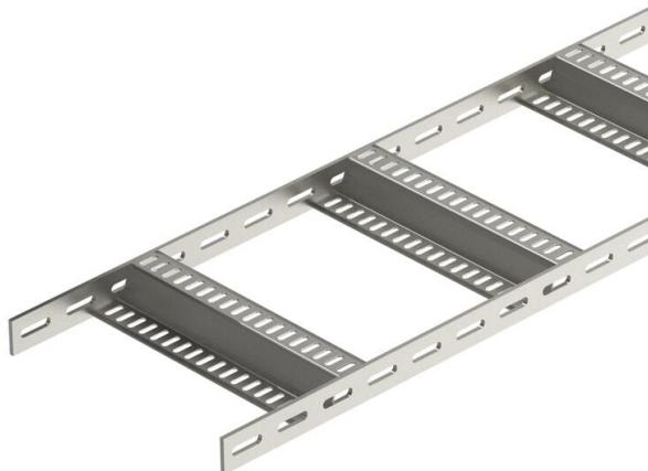
Échelle à câbles, version navale, avec longeron perforé d'une hauteur latérale de 40 mm, avec échelons en Z soudés et perforés Charge testée selon CEI en combinaison avec les raccords de type SLV.
