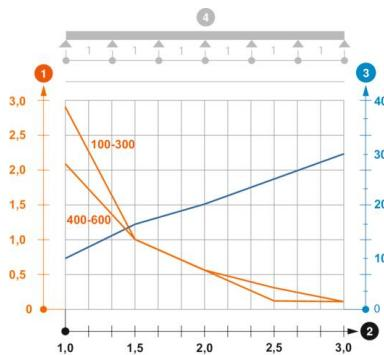
Diagramme de charge échelle à câbles type SLZ LA2
