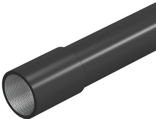
Tube d'installation électrique selon EN 61386-1 avec extrémités filetées selon la norme DIN EN 60423, pour la protection mécanique de câbles et de fils.
