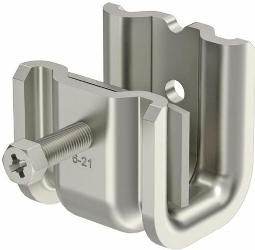
Ce type de pince de fixation est poussé sur le support et fixé sur le support ou un fer plat au moyen d'un patin de pression et d'une vis (M8). La vis hexagonale est dotée d'une ouverture de clé 10 mm. Il y a également deux filets M8 supplémentaires dans le corps de serrage, par exemple pour fixer des tiges filetées.
