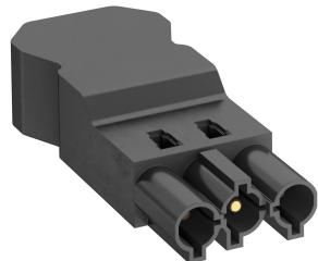
Connecteur mâle à 3 pôles, type GST18i avec raccord à vis pour conduites 1,5 - 4,0 mm<sup>2</sup> pour une section de 10,5 à 14,5 mm (H05VV, NYM), non monté avec décharge de traction, possibilité de confection sur place, 250 V, 16 A.
