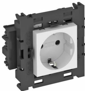
Prise de courant à contact de protection à raccordement latéral simple 0°, avec protection renforcée contre les contacts accidentels, avec bornes à fiche, 2 pôles, 16 A, 250 V~, avec bornes de raccordement selon CEI 60884-1, convient pour le montage dans les systèmes de canaux de montage d'appareillage Rapid 80.
