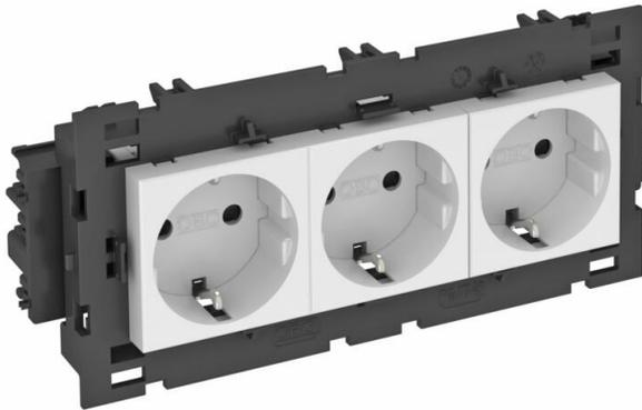
Prise de courant à contact de protection à raccordement latéral triple 0°, avec protection renforcée contre les contacts accidentels, avec bornes à fiche, 2 pôles, 16 A, 250 V~, avec bornes de raccordement selon CEEI 60884-1, convient pour le montage dans les systèmes de canaux de montage d'appareillage Rapid 80.
