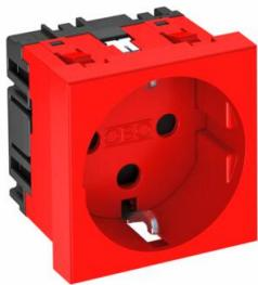
Prise de courant à contact de protection simple 0°, version codée, avec protection renforcée contre les contacts accidentels, avec bornes à fiche, 2 pôles, 16 A, 250 V~, avec bornes de raccordement selon CEI 60884-1.
