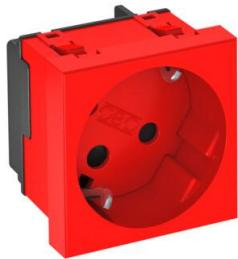
Prise de courant à contact de protection simple 33°, version codée, avec protection renforcée contre les contacts accidentels, avec bornes à fiche, 2 pôles, 16 A, 250 V~, avec bornes de raccordement selon CEI 60884-1.
