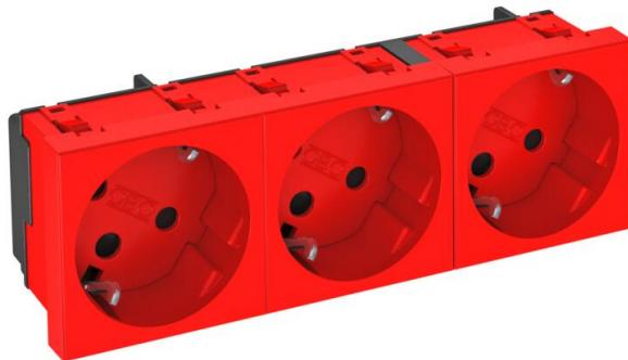
Prise de courant à contact de protection triple 33°, version codée, avec protection renforcée contre les contacts accidentels, avec bornes à fiche, 2 pôles, 16 A, 250 V~, avec bornes de raccordement selon CEI 60884-1.
